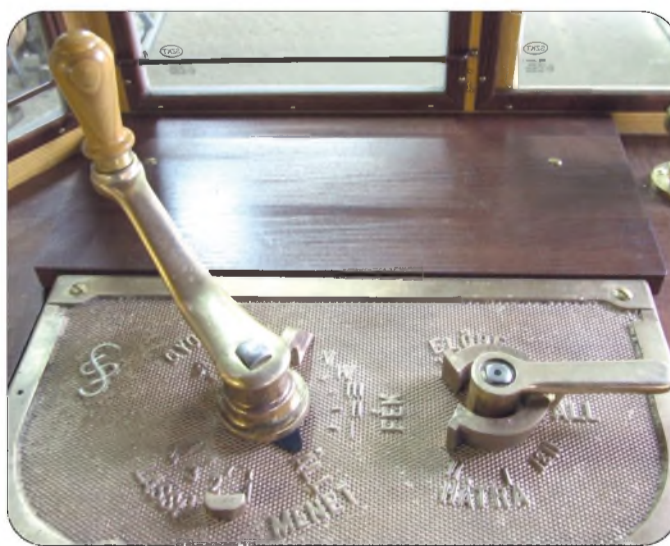
Menetkapcsoló (baloldalt) és irányváltó. Utóbbiból egy van, volt motorkocsinként, nem véletlenül: így biztos nem lopták el, és biztos, hogy a villamos másik vezetőállásán senki nem viccelte meg a villamosvezetőt, hogy átkapcsolja az irányváltót.
